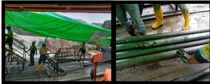
Gambar.4.6. Pengeboran dan Pengualaran Inner Tuben Waktu edar (Cycle Time)
